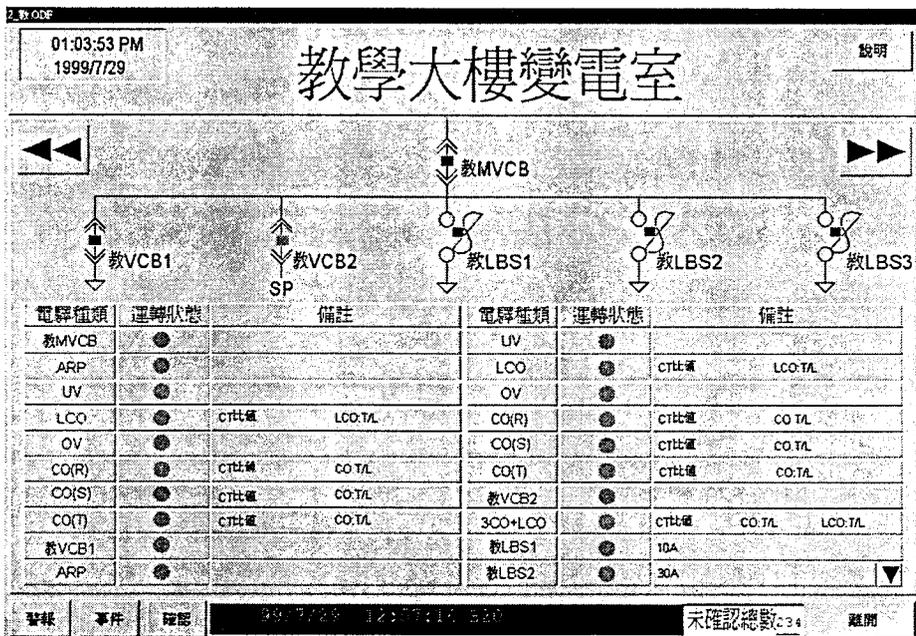
圖七 變電站開關狀態及保護電驛設定子畫面
