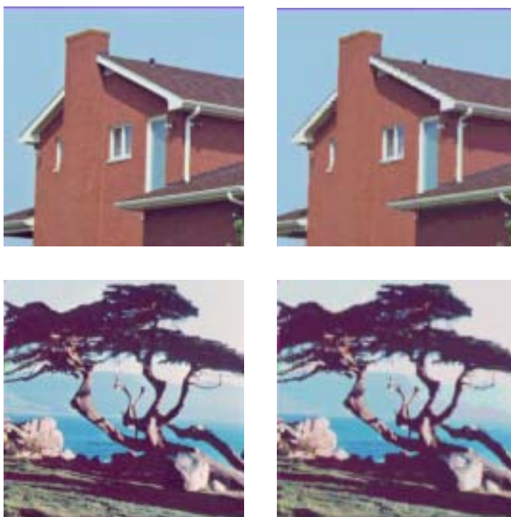
圖五、來自於硬性 C-均值彩色向量量化演算法對 RGB 各平面編碼簿大小為 128 所建立之“House”及“Tree”原始彩色影像(左)，及重建彩色影像(右)，其平均 PSNR 分別為 28.725 dB 及 25.164 dB
