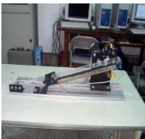
圖一、鋼球定位系統硬體機構
