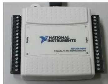
圖 9. USB-6009 DAQ 訊號擷取器
