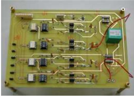
圖 6 電源驅動板構造圖
