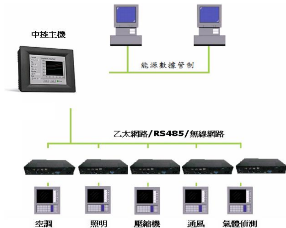
圖 3. 傳統的遠端能源監控系統架構圖
