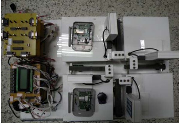
圖 10. 所研製之交通號誌流量控制模擬的實體圖
