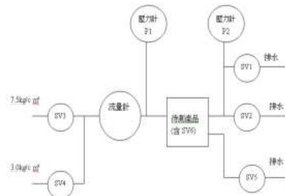
圖 9、水路檢測架構
