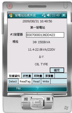
圖 5. PDA 巡視器顯示電子標籤的編號及巡視點設備的基本規格資訊
