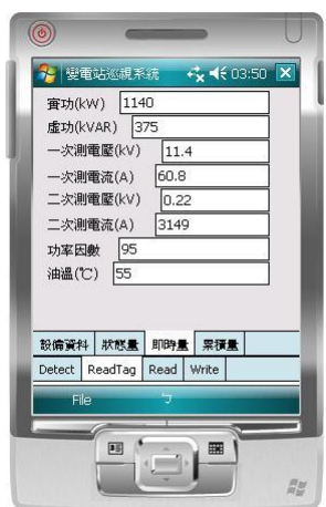
圖 7. PDA 巡視器顯示設備巡視內容—即時量畫面
