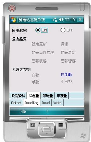
圖 6. PDA 巡視器顯示設備巡視內容—狀態量畫面
