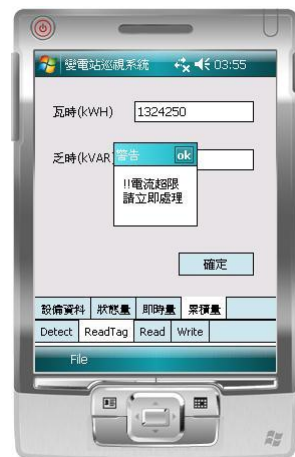
圖 10. 跳出此設備電流超限的對話框
