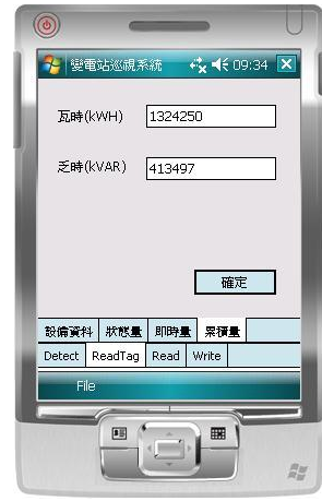
圖 8. PDA 巡視器顯示設備巡視內容—累積量畫面
