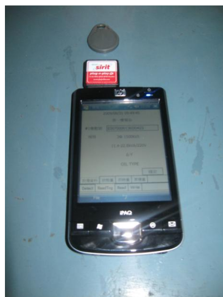
圖 4. PDA 巡視器讀取變壓器設備電子標籤近照
