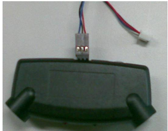
圖9、超音波感測器示意圖
