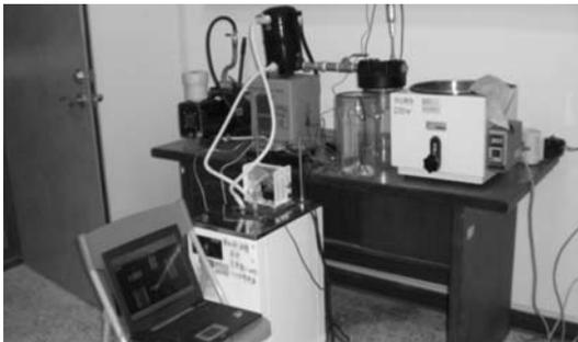
圖4 真空凍結乾燥系統實體
