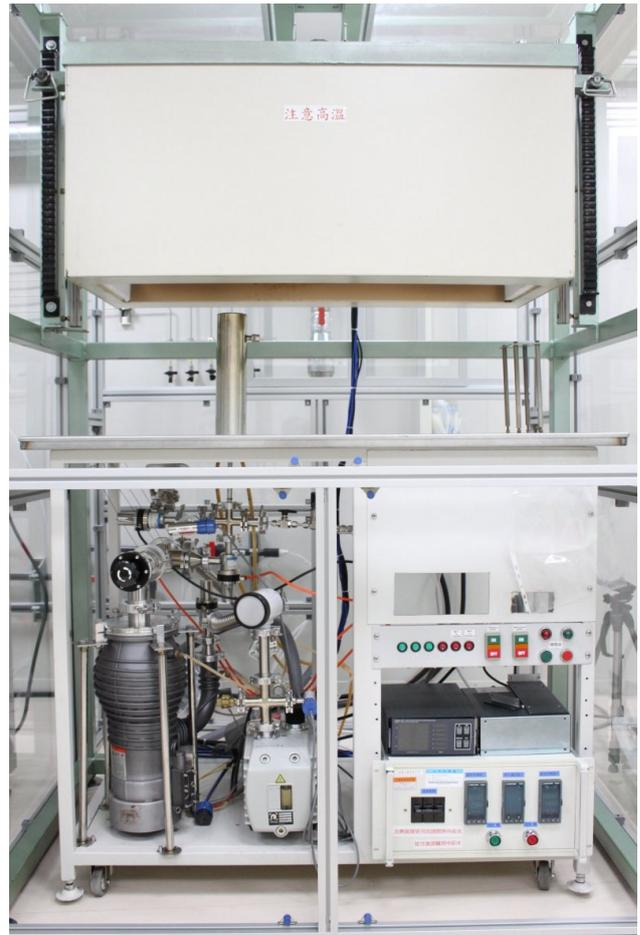
圖 2. 熱處理封裝機實體照片
