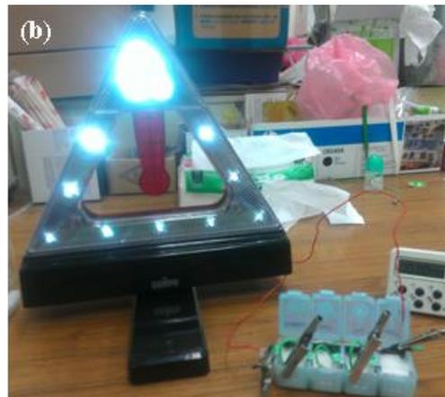
圖 10. (a)鋁空氣電池原型於 100 mA 放電電流下放電電壓對應放電時間之曲線圖；(b)鋁空氣電池原型(圖右下方)驅動 LED 故障警示三角架。
