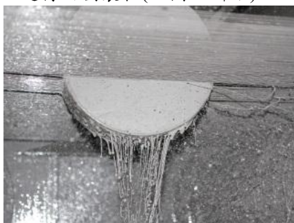
圖三. 游離磨漿搭配鍍銅切割線[12]
