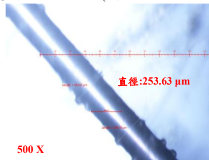
圖十. 鑽石切割線直徑量測
