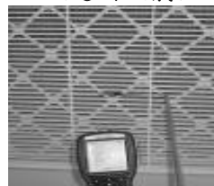
圖 25.紙框濾網回風口風量測情況
