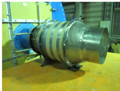
圖 14: 縮小 0.415 倍製造之同軸管道風機模型機
