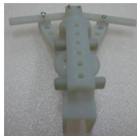
圖 3-4 拍翅機構的組裝相片
