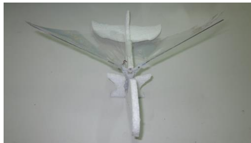
圖 3-5 微型拍翅飛行器機體的成品
