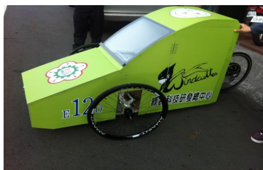
圖 21. 車殼安裝完成於車架上
