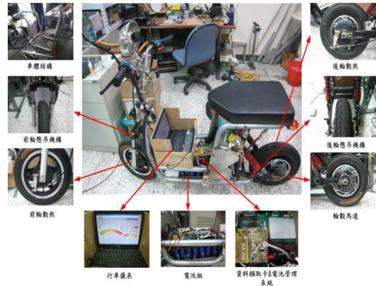
圖 16. 實驗電動摩托車整體完成架構圖
