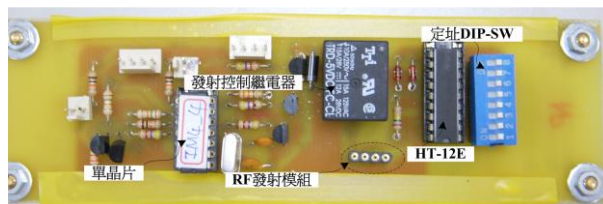
圖 4. 裝置在室外端信箱內之控制板雛型(包含了 RF 無線模組發射器)
