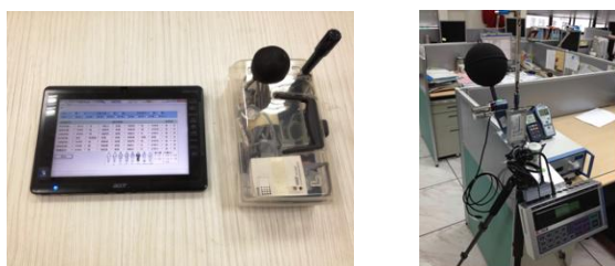
圖 3a、逐點測量儀器 圖 3b、定點測量儀器
