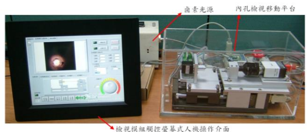
圖七 所設計架設之內孔檢視離型模組。
