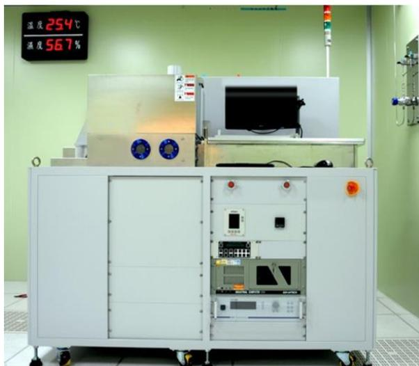
圖 1. 鍍膜驗證的電漿輔助氣相沉積系統
