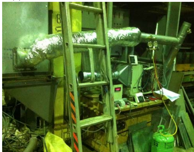
圖(6) 模型-循環式小型乾燥機
