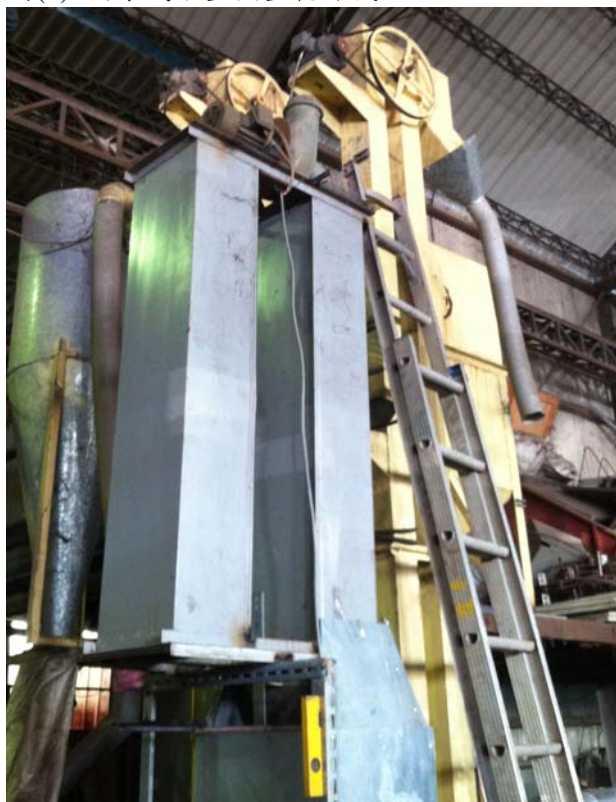
圖(5) 循環式小型模型乾燥機
