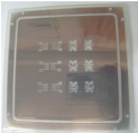
圖 5 表面聲波應變計玻璃光罩
