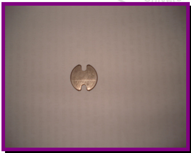
圖 18. 鈦合金以模具沖壓成型之試片 (D20mm*2mm)
