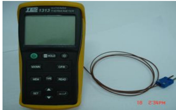
圖 3.5 (a)數位式(TES-1313)溫度計
