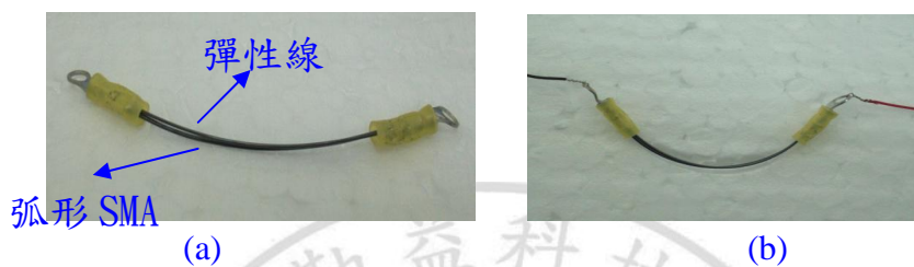
圖 4.2 弧形記憶合金加彈性線 (a)未通電 (b)通電
