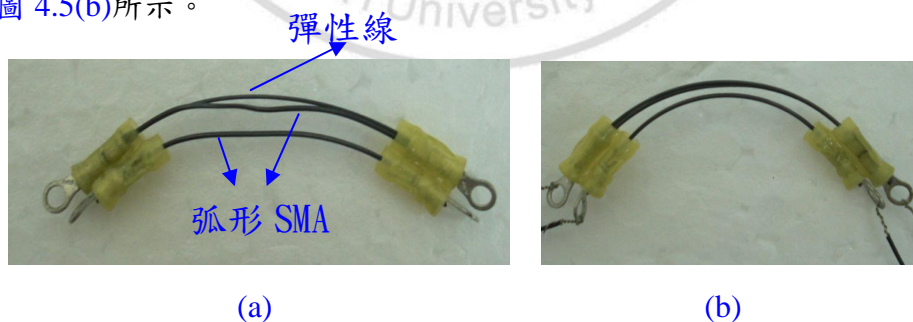
圖 4.5 兩條弧形記憶合金加彈性線 (a)未通電 (b)通電
