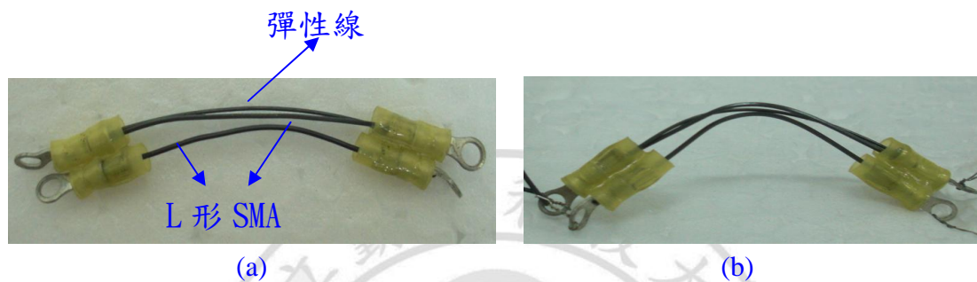
圖 4.4 兩條 L 形記憶合金加彈性線 (a)未通電 (b)通電
