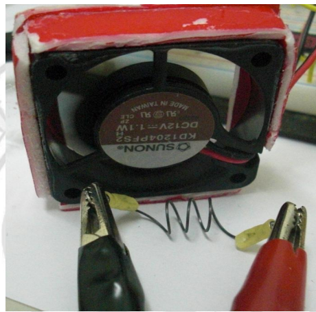
圖 6.5 未加入 PWM、加入 PWM 及 PWM 與風扇散熱量測方法
