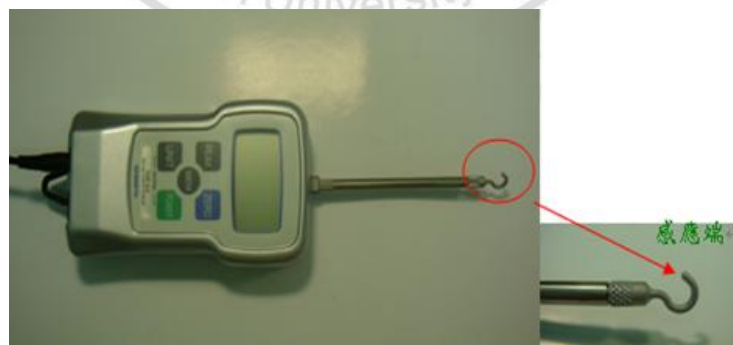
圖 3.4 微拉力計及感應端圖
