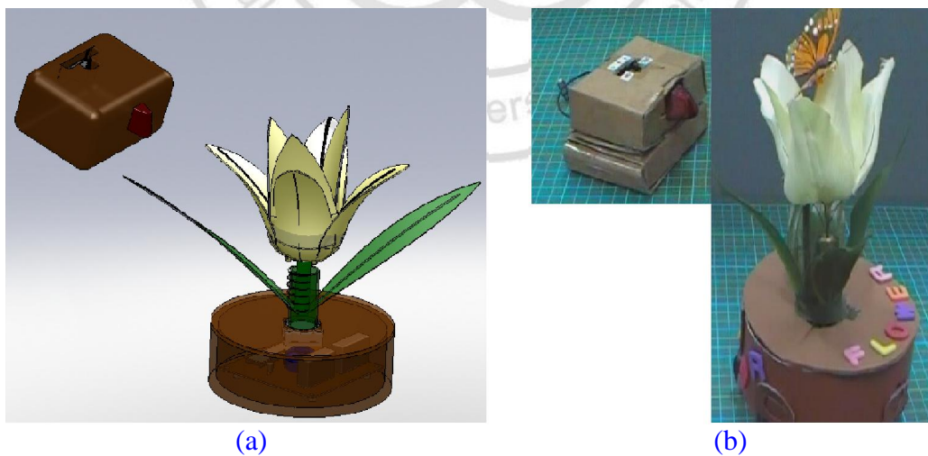
圖 8.25 (a) 遙控花電腦模擬實體模型 (b) 遙控花實體照片
