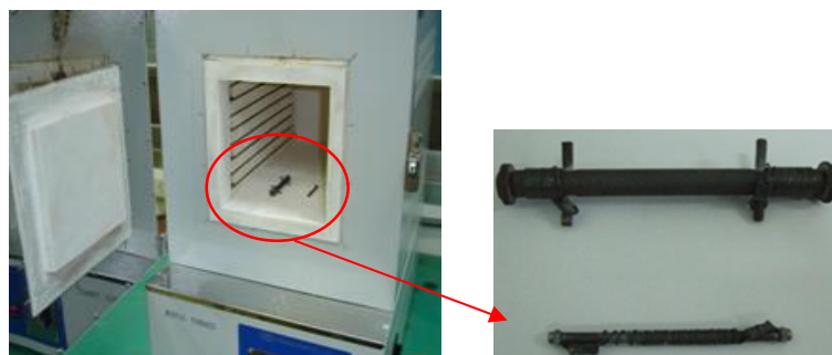
圖 3.7 待加熱的 SMA 放置高溫加熱爐內
