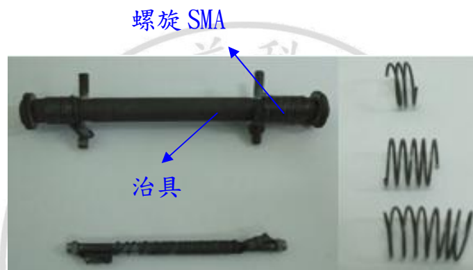
圖 3.20 螺旋彈簧記憶合金製作
