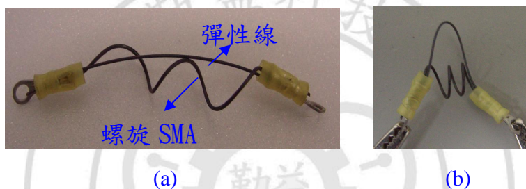
圖 4.7 螺旋彈簧狀 SMA 外側加彈性線 (a)未通電 (b)通電
