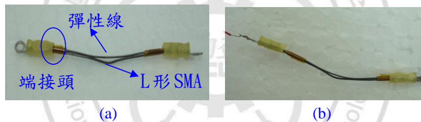
圖 4.1 L形記憶合金加彈性線 (a)未通電 (b)通電
