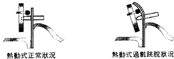
圖2.1 熱動式斷路器作動原理
