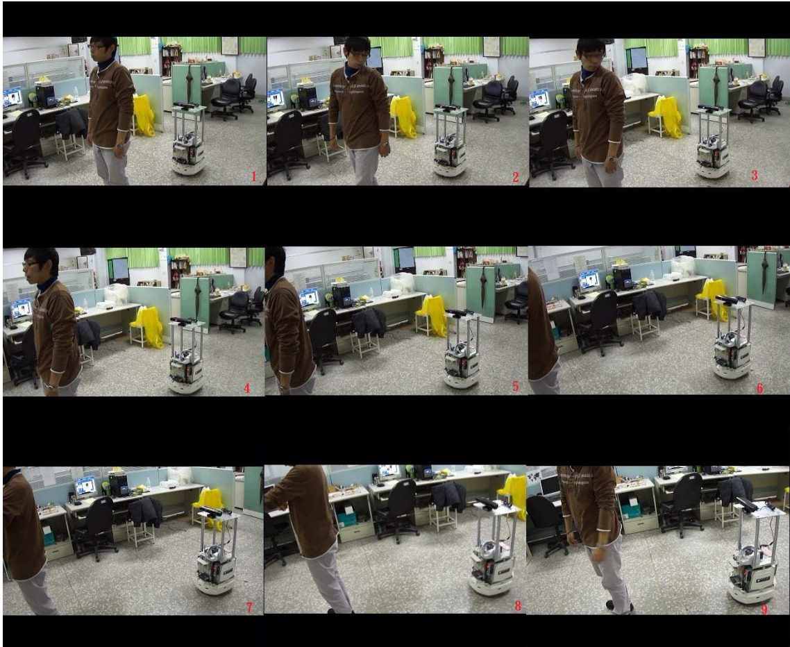
圖 4-9 追蹤控制系統測試
