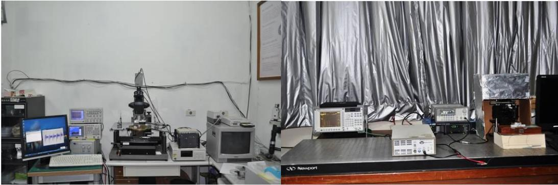
圖 5-22 裝置雷射位移計系統與 MTI-2000 非接觸光纖測量儀量測圖
