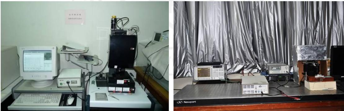
圖 5-20 共軛焦 3D 光學表面形貌量測儀與 MTI-2000 非接觸光纖測量儀圖
