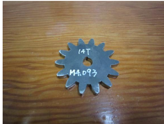
第 65 圖 M4.09302X14T 固定行星齒輪成品
