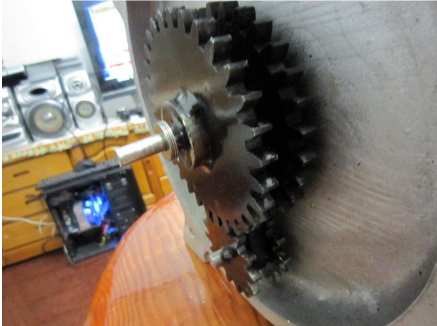
第 73 圖加上從動太陽齒輪及輸出軸
