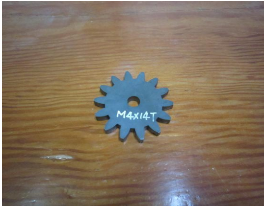
第 64 圖 M4X14T 從動行星齒輪成品
