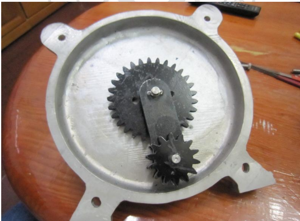
第 72 圖固定太陽齒輪、擺臂及行星齒輪組
