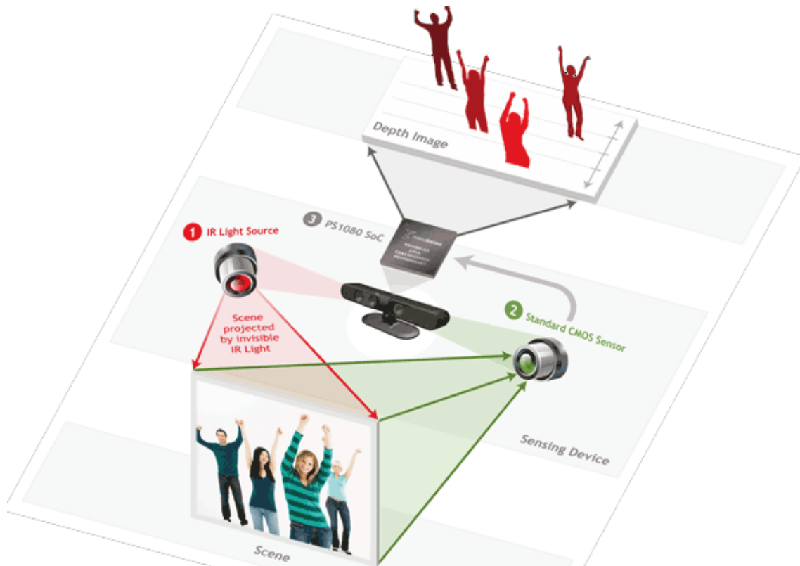
圖 3.5 Kinect 感測器運作流程 資料來源：PrimeSense
