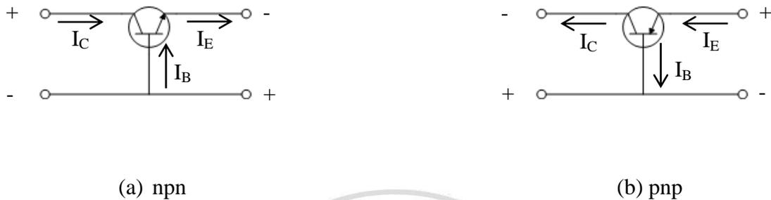
圖 3.10 電晶體的電流方向
