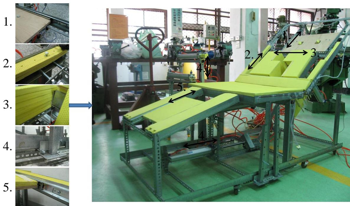
圖 5.8 滑槽設計示意圖
