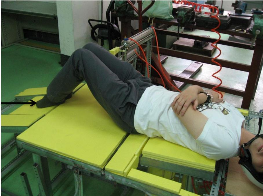
圖 5.16 機構隨著箭頭方向移動，驅使患者呈屈膝動作。
