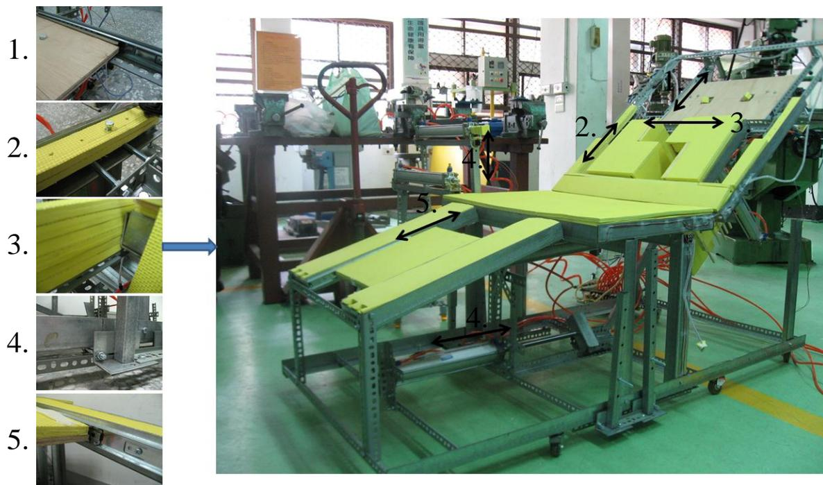
圖 5.8 滑槽設計示意圖
