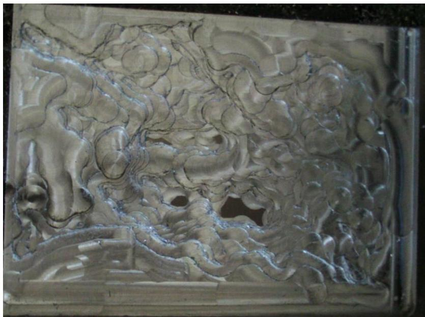
圖 80、 $\varnothing 12$  平銑刀多層投影粗加工 1/5
