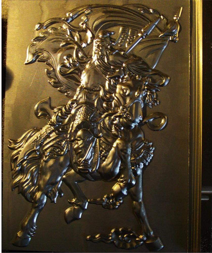
圖 98、使用往復式投影精加工；可看出工件表面無轉角痕跡 4/4
