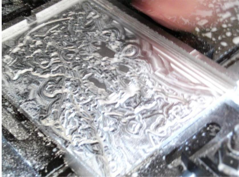
圖 71、Ø4 平銑刀殘料等高再加工 3/5
