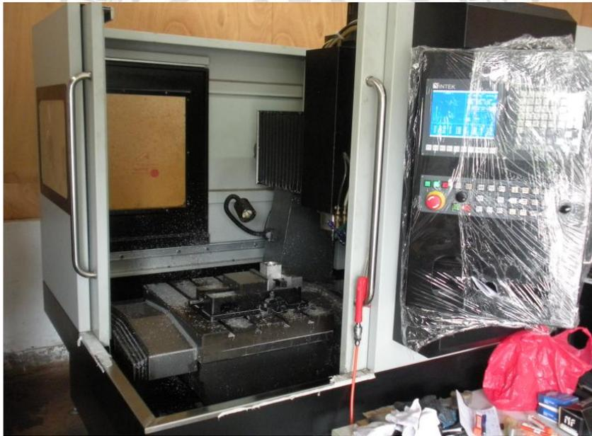
圖 65、此次加工所使用的小型龍門式高速雕銑機
