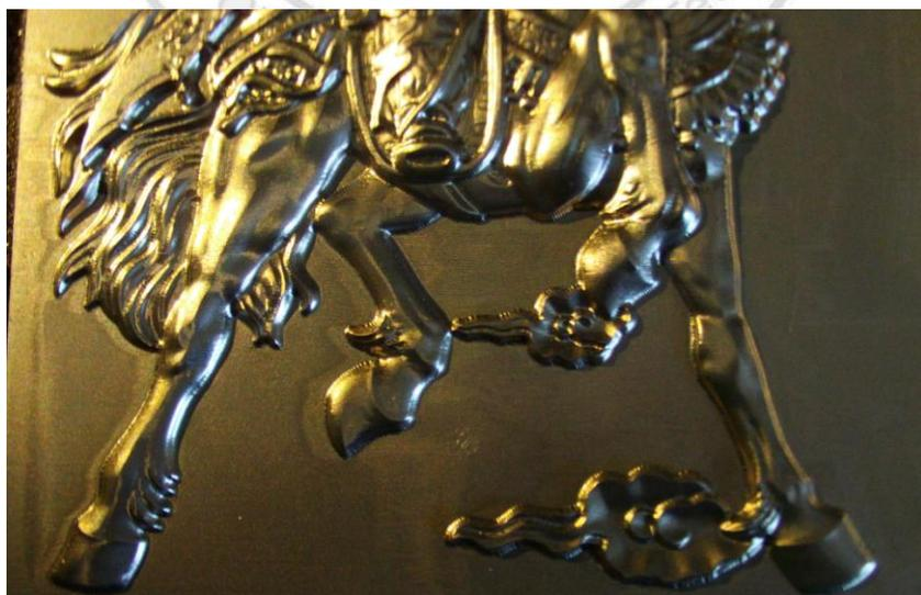
圖 97、使用往復式投影精加工；可看出工件表面無轉角痕跡 3/4
