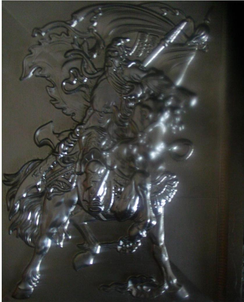
圖 103、使用環繞式投影精加工可發現工件表面在轉角處有明顯斜線 4/4
