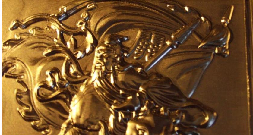
圖 95、使用往復式投影精加工；可看出工件表面無轉角痕跡 1/4
