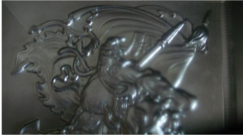
圖 100、使用環繞式投影精加工可發現工件表面在轉角處有明顯斜線 1/4
