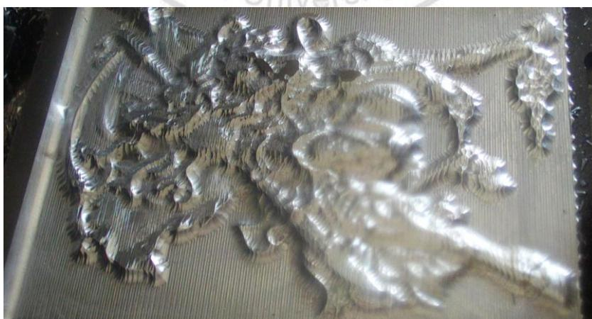
圖 77、R6 球銑刀往復式投影粗加工（第三層深度 6mm）3/5
