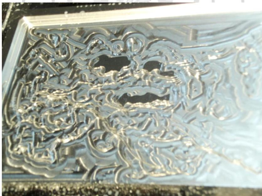
圖 70、 $\varnothing 6$  平銑刀殘料等高再加工 2/5
