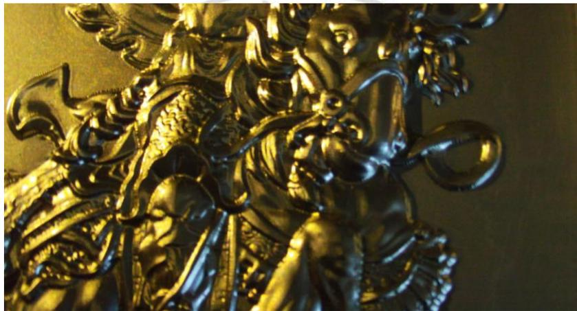
圖 96、使用往復式投影精加工；可看出工件表面無轉角痕跡 2/4
