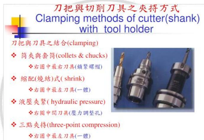
圖 50、高速加工刀把與切削刀具夾持方式 1/5[11]
