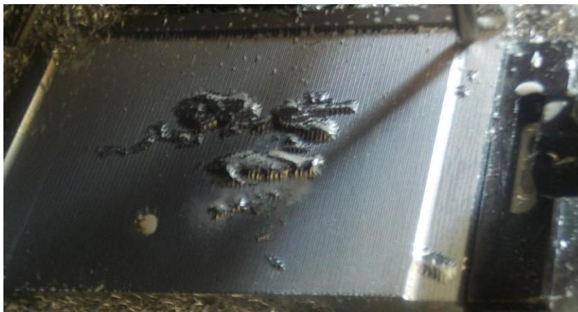
圖 75、R6 球銑刀往復式投影粗加工（第一層深度 2mm）1/5
