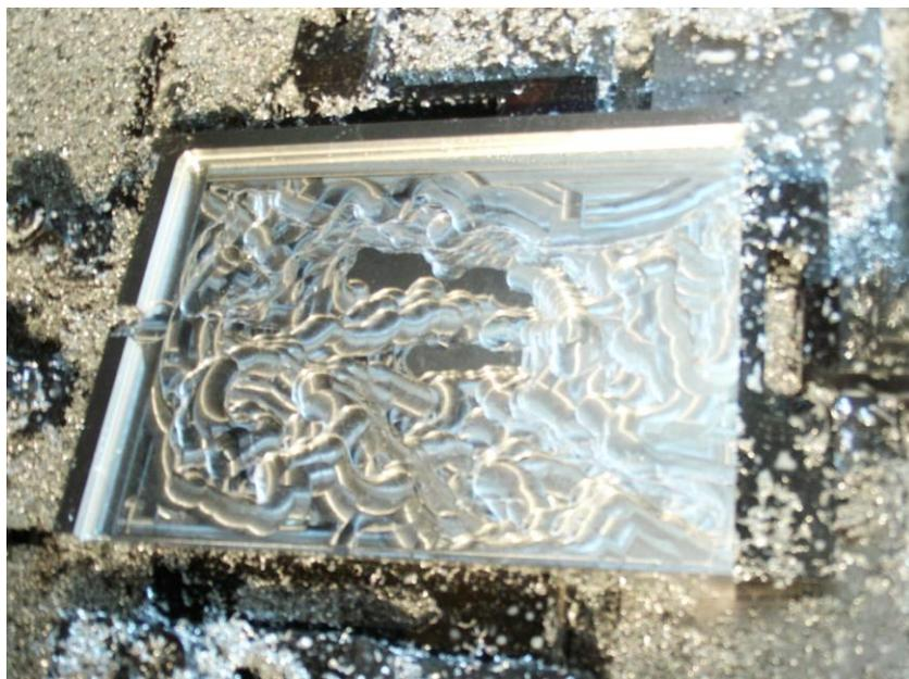
圖 69、 $\varnothing 12$  平銑刀等高粗加工 1/5
