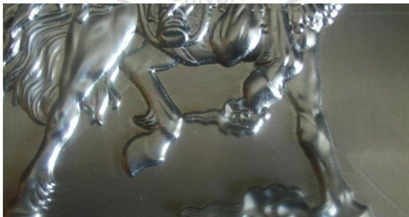
圖 102、使用環繞式投影精加工可發現工件表面在轉角處有明顯斜線 3/4
