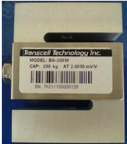
圖 3-2 壓縮實驗用荷重元(Transcell Tech. Inc. Model:BA-200M)
