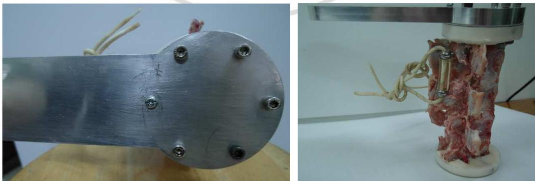
圖 3-13 壓縮試驗-鋁材板塊與完成椎體試件
