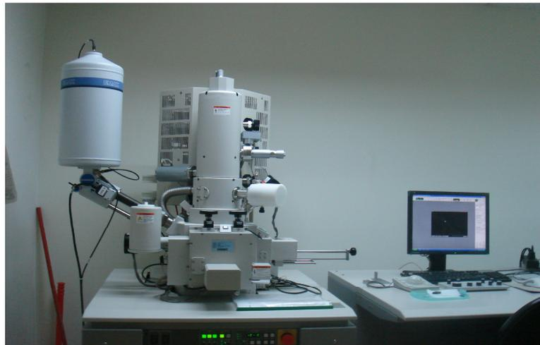
圖 3-7 場發射式電子顯微鏡
