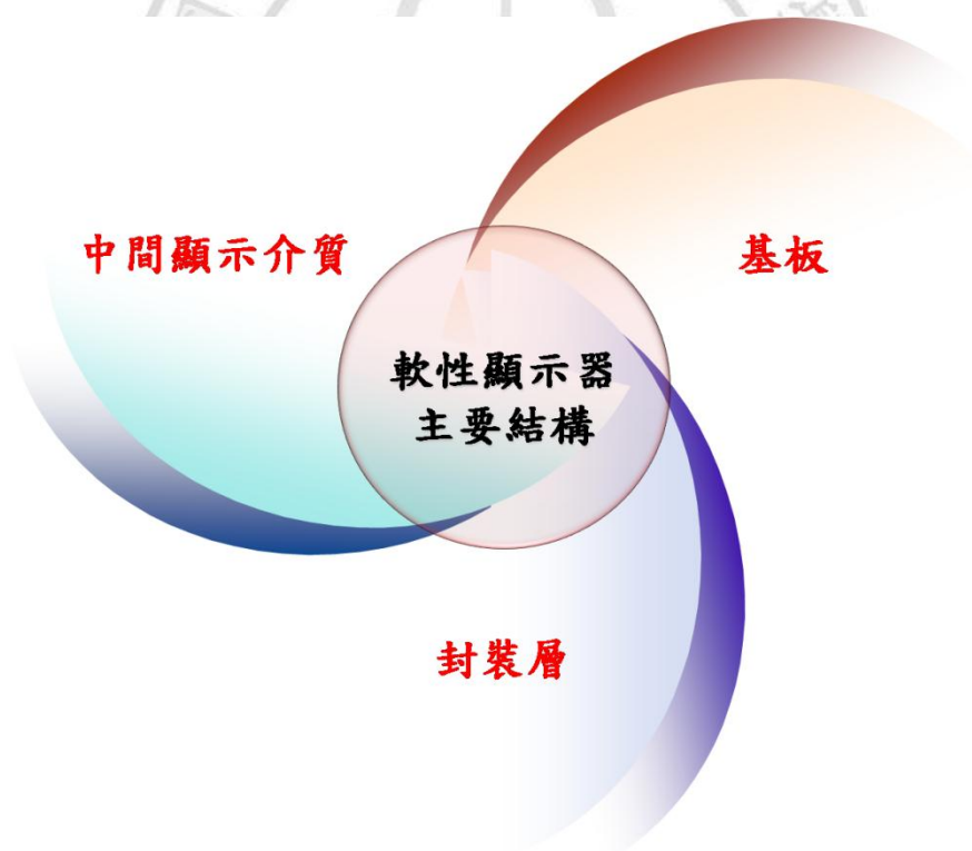
圖 1.14. 軟性顯示器之主要結構
