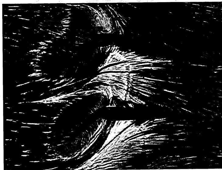
圖 6.2-17 添加 5phr 200~400 \mu\text{m} TPU 微球在硬化條件(編號 B)在 H-3031 硬化系統中增韌 Epoxy 之光學顯微鏡圖，觀察其破壞表面。(×150)
