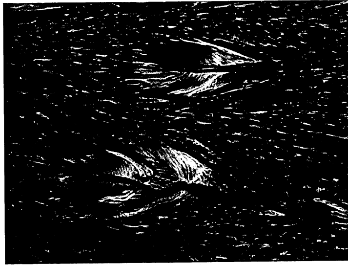
圖 6.2-18 添加 5phr 200~400 \mu m TPU 微球在硬化條件(編號 B) 在 H-3031 硬化系統中增韌 Epoxy 之光學顯微鏡圖，觀察其破壞表面。(×150)
