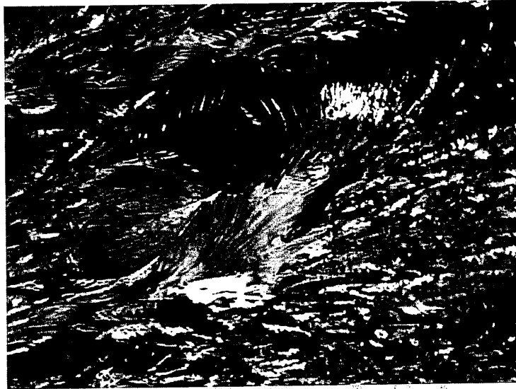
圖 6.2-14 添加 5phr 200~400 \mu\text{m} TPU 微球使用預膨潤法硬化條件(編號 C)在 H-3031 硬化系統中增韌 Epoxy 之光學顯微鏡圖，觀察其破壞表面。(x150)
