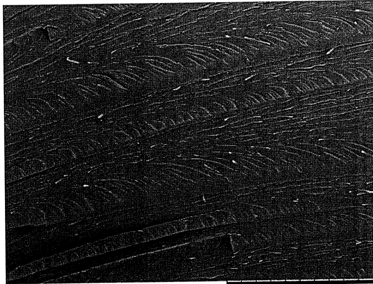
圖 6.2-12 純 Epoxy 在 H-3031 硬化系統中之 SEM 圖 (放大 150 倍), 觀察其破壞表面。(×150)
