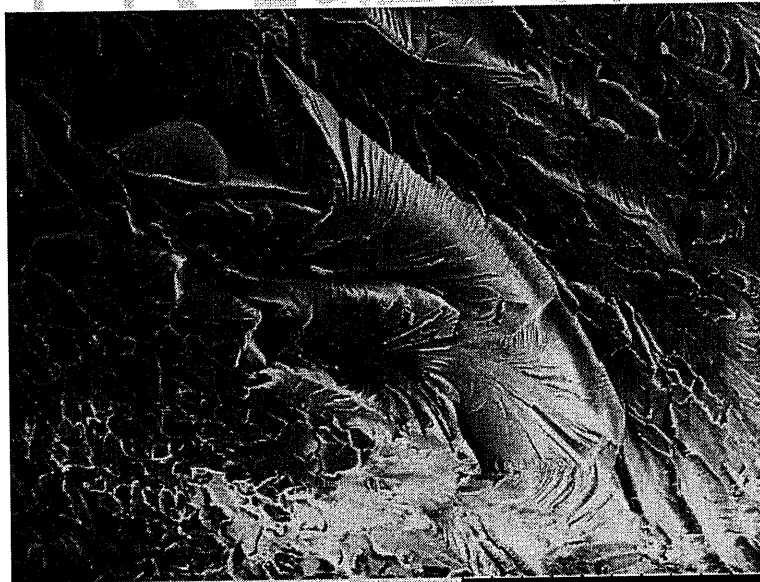
圖 6.2-12 純 Epoxy 在 H-3031 硬化系統中之 SEM 圖 (放大 150 倍), 觀察其破壞表面。(×150)
