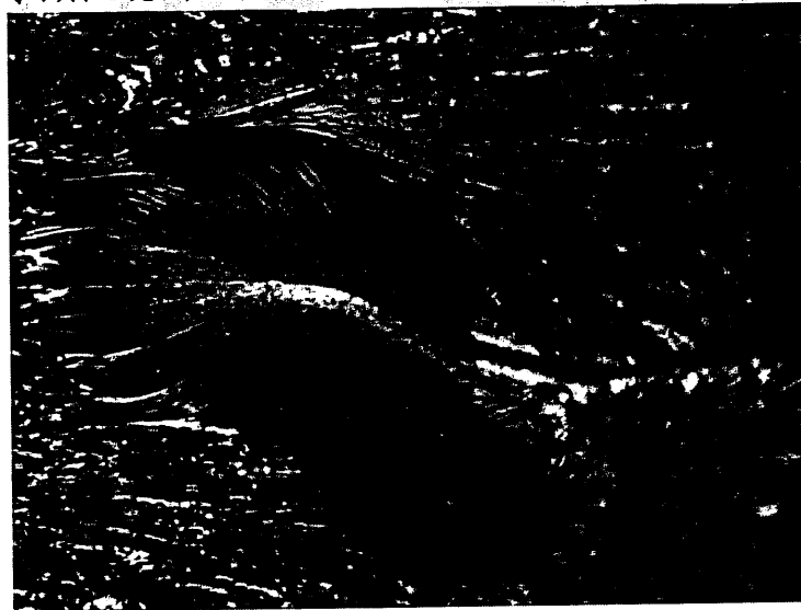
圖 6.2-15 添加 3phr 200~400 \mu\text{m} TPU 微球使用預膨潤法硬化條件(編號 A)在 H-3031 硬化系統中增韌 Epoxy 之光學顯微鏡圖，觀察其破壞表面。(x150)
