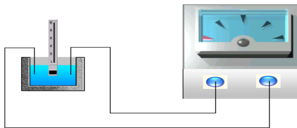
圖 4.1.1. 簡易共晶點測量圖
