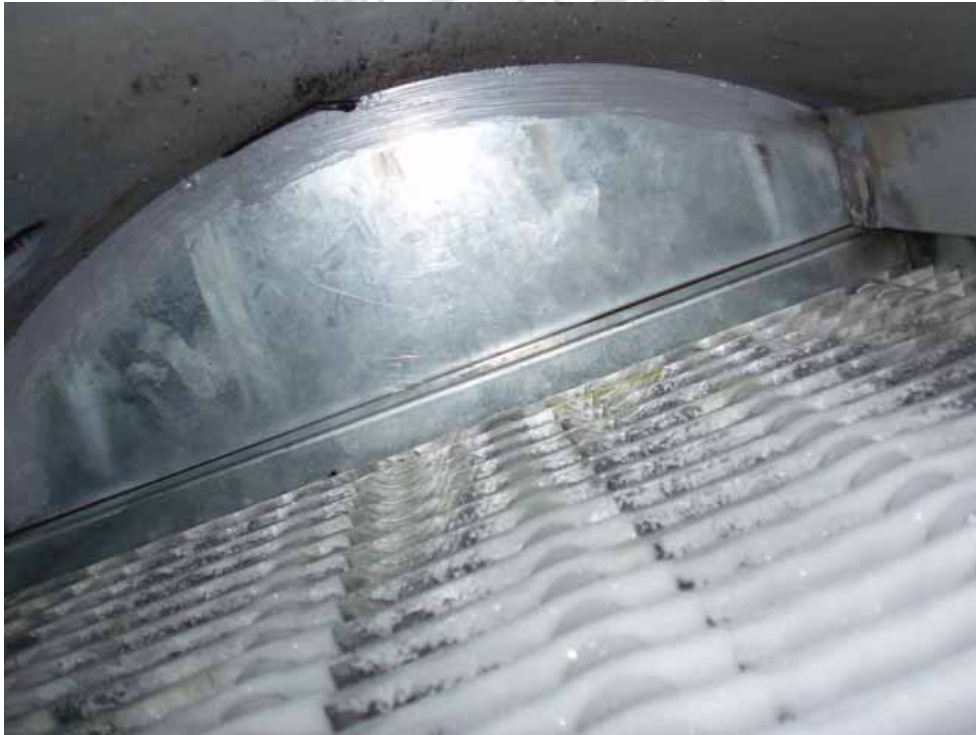
圖 3.3.1 真空凍結乾燥機冷阱
