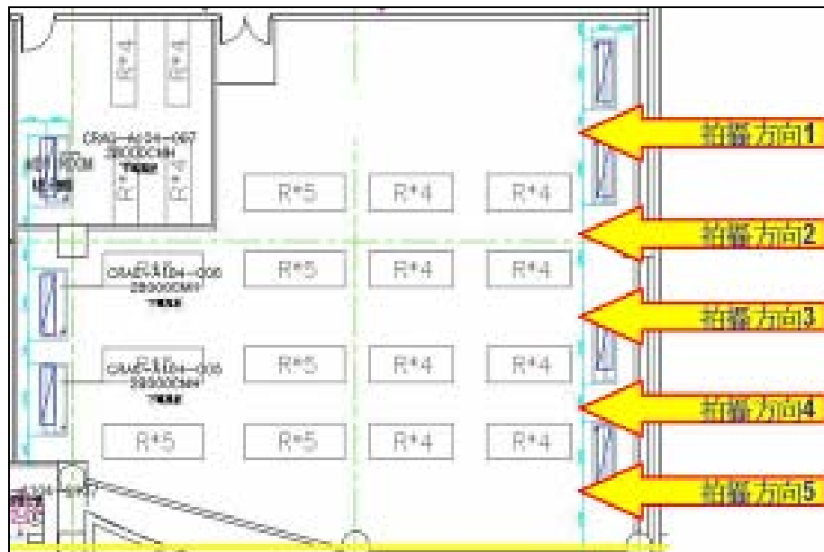
圖 3.10、A 棟 CRAC 熱顯像儀(IR)拍攝角度
