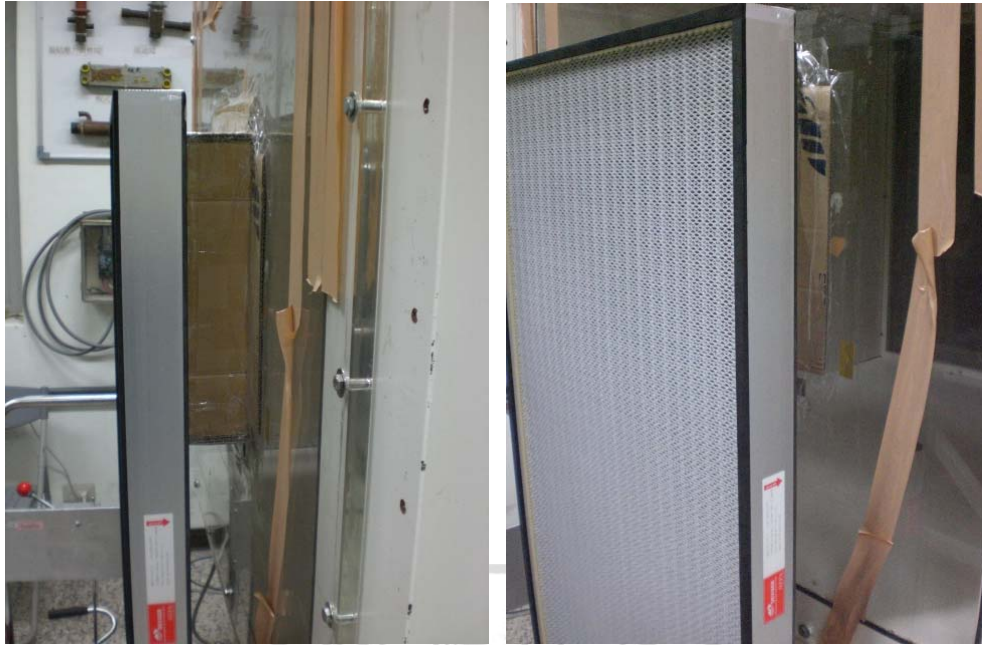
圖 2-6 入風口以外的面積用紙板遮蔽
