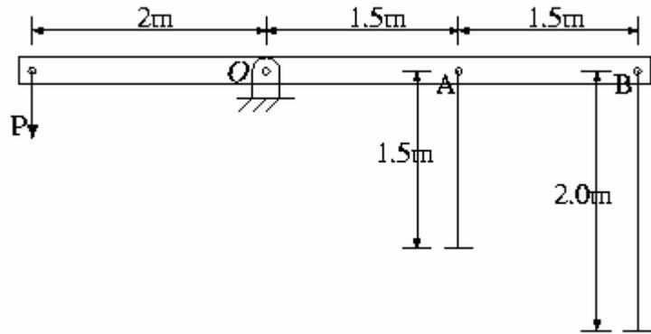
四、如圖所示，畫其剪力圖及彎矩圖，標示各個變化之值，並求其最大拉伸與壓縮彎曲應力的大小及位置。其截面尺寸如圖。(25%)
