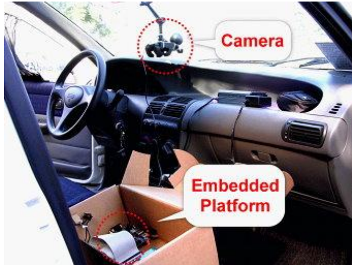
圖1.8 實際道路測試之系統架設
