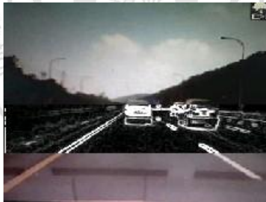
圖3.4 將 ROI 中灰階影像經由 Sobel 水平與垂直邊緣偵測後之影像
