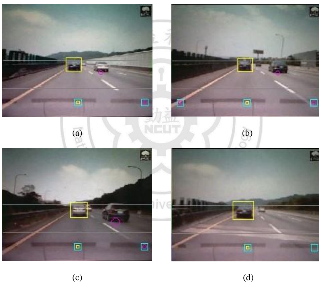
圖7.2 行駛於內側車道車輛偵測結果 (a) (b) (c)兩線車道上皆有車道 (d)車輛行駛於顏色不均的道路
