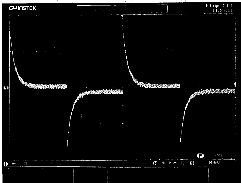
圖 3.23 速度控制迴路命令 \pm 500 rpm 實作，示波器儲存畫面
