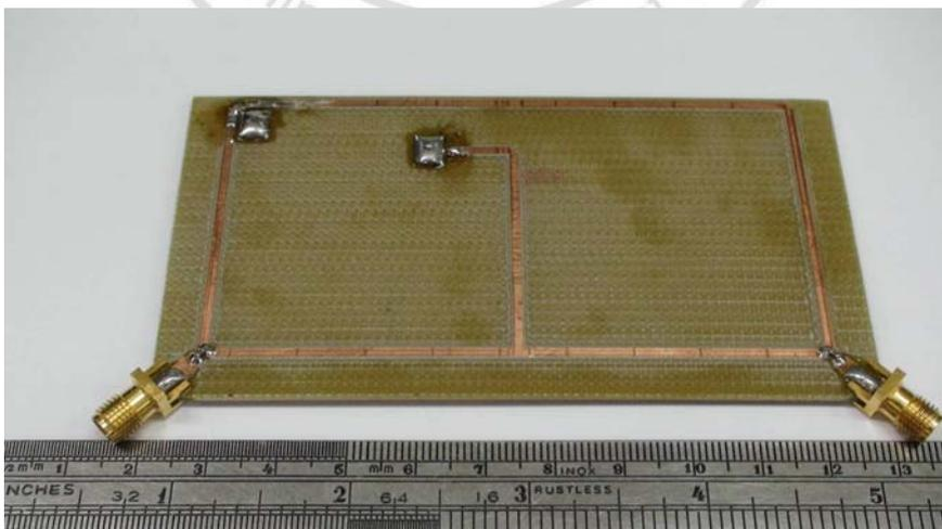
圖 4.1 (b) 使用固定電容且中心頻率為 0.925GHz 之實體圖
