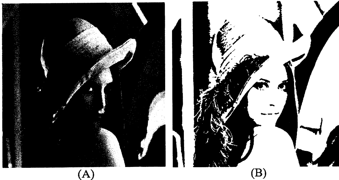
圖 2-9 二值化運算示意圖：(a)二值化前影像；(b)二值化後影像。
