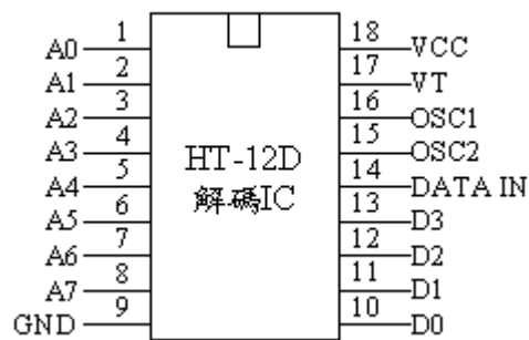
圖 3.9 HT-12D 解碼 IC 接腳圖
