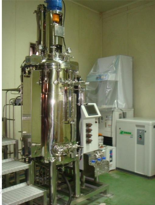
圖 6 觸控式全自動滅菌醱酵槽
