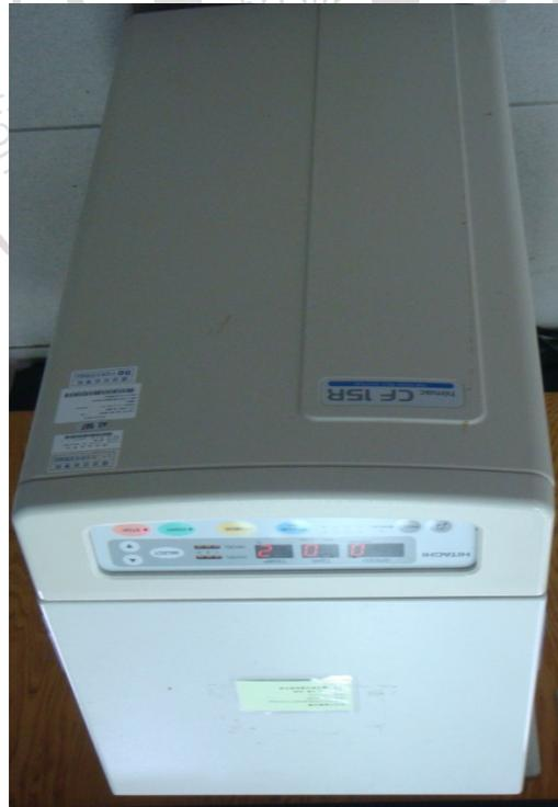
圖 11 高速冷凍離心機
