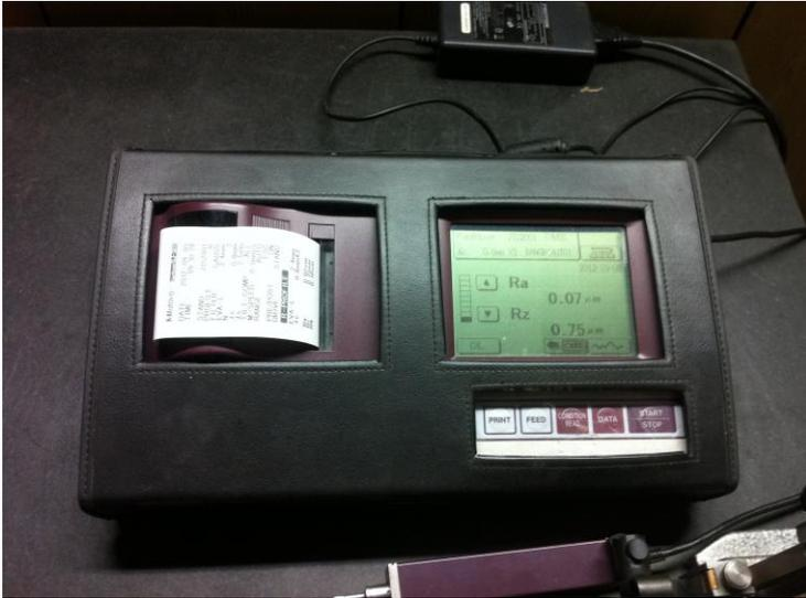
圖 11 表面粗糙度測量儀
